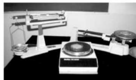
Fig.1.9 En el laboratorio la masa se determina con balanzas: a) de un platillo b) de brazo triple c) granataria eléctrica
